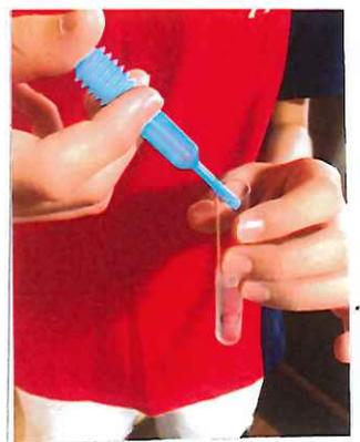
⑤ ④の試験管にふたをしてゆくりかたむけまぜる。白い綿のような「モヤモヤ」が見える。
